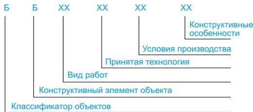
Рис. 1. Классификационные признаки ресурсно-технологической модели: **XX** – порядковый цифровой шифр, **Б** – буквенное обозначение
